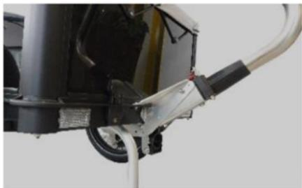
Schloss muss geöffnet sein beim Ein- und Ausstecken der Deichseln. links drehen = geöffnet. Der Schlüssel bleibt im Schloß!
